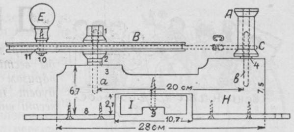
Рис. 2. Основание машины Н; шпильки для насадки колеса и катушки а и в; шайбы под них 3 и 4; диск вращения В; ручка вращения Е; ее винт 11; шайба под ним 10; половинки катушек 1 и 2; приводной ремень с
